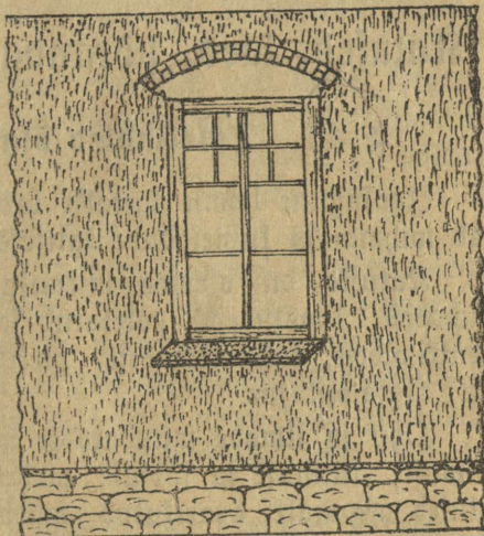
48. Akende- ehk ustepealsete võlmitine telliskividega ehk betooniga ja vihmalaud.
