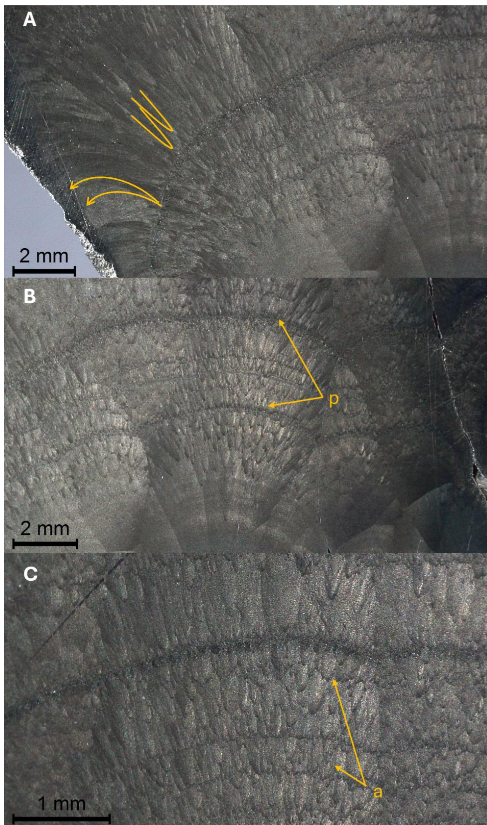
Joonis 5. Lähivaated (A, B, C) mugulja-radialkiirelise püriidiagregaadi ristlõikest ning mikrotektstuuridest peegeldavas valguses. (a - koonus-lehvikukujuliselt organiseeritud kristalliidid, p - kihtide vahelised piirpinnad)
