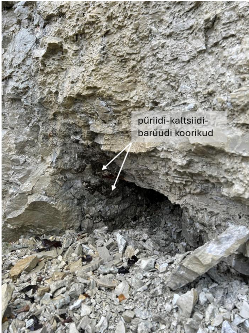
Joonis 2. Püriidi-kaltsiidi-barüüdi koorikute ja agregaatide koopalaadne struktuur Otisaare karjääri uuema (põhjapoolse) osa seinajalamil oktoobris 2023. Laius ca. 1.5 m, kõrgus ca. 0.7-0.8 m. Autori foto (Täär, 2024).
