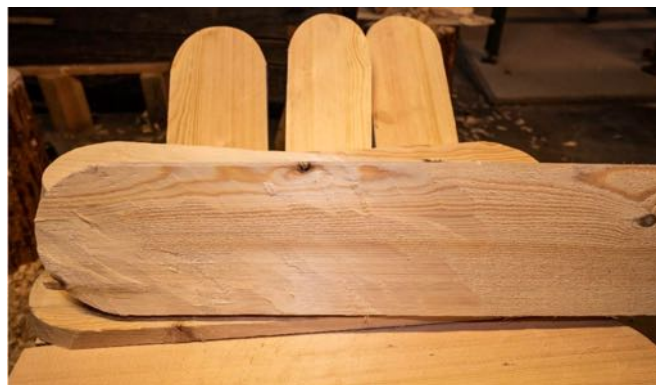
Joonis 11. Kimmi tagakülje tahumine (Allikas: Sjöberg, 2018)
