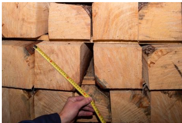
Joonis 6. Kimmiklopid. (Allikas: Sjöberg 2018)
