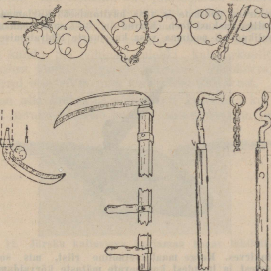
Pilt 10. Põõsa juurimisel põõsa poolitamiseks tarvitatav kepp ja kett (üleval pahemal, kõrval — võsavikat). All — Ketki kinnitamine kepi abil põõsa ümber ja põõsa poolitamine.
