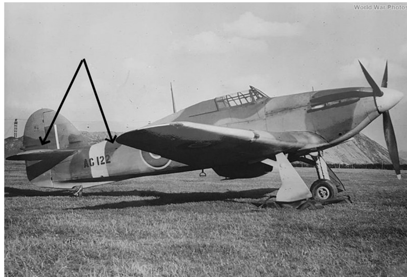
Joonis 1. IFF-süsteemi antenni trajektoor Hawker Hurricane'i tüüpi lennukil
