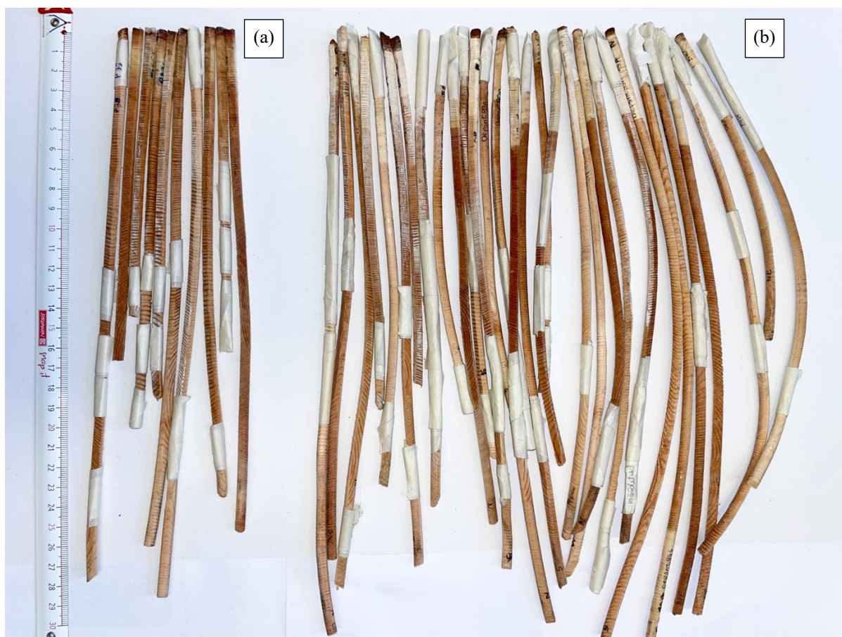
Joonis 6. Vaigutusarmide dateerimiseks (a) ja kaevikute mõju (b) uurimiseks kogutud puidu puurproovid (autori foto).
