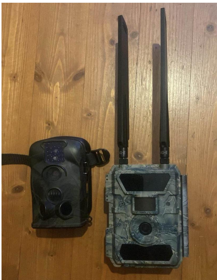
Pilt 1. Kaks versiooni PIR rajakaameraid. Vasakul mittesaatev ja paremal saatev versioon. (Autori pilt)
