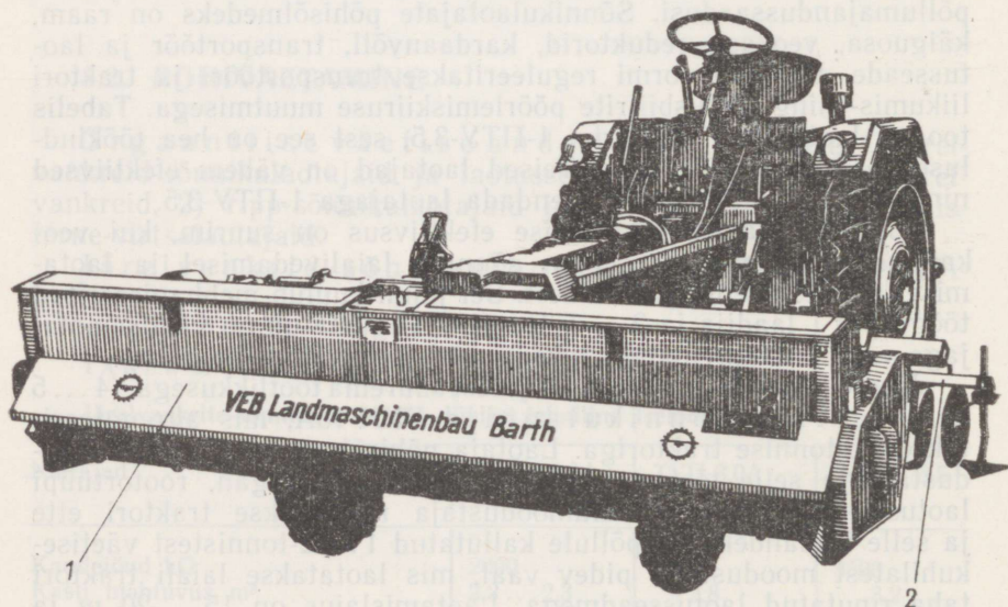
Joonis 19. Mineraalväetise külvimasin D 344 St kompleksagregaadis vaheltharimiskultivaatoriga P 420:
