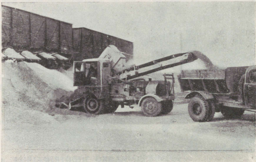
Joonis 30. Restpõlevkivituhha laadimine kallurautole Põlva estakaadil. Taga vasakul avatud põhjaluukidega tuhavagunid. (E. Turbase foto.)
