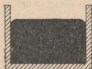
Joon. 81. Mittemärgava vedeliku kumer menisk.
