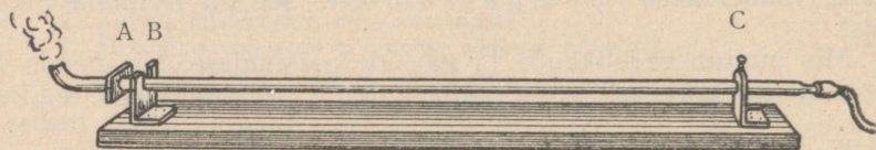
Joon. 45. Lermantovi katseriist joonpaisumise koefitsiendi määramiseks.
