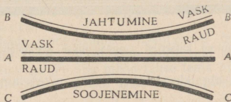
Joon. 44. Vasest ja rauast kokkuneeditud riba paindumine soojenemisel ja jahtumisel.
