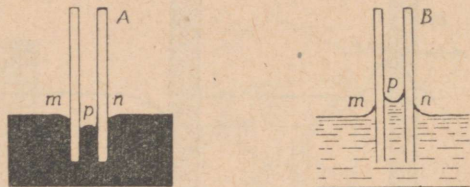
Joon. 82. Menisk torudes: A — mittemärgamise puhul; B — märgamisel.
