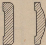
Joon. 177. Lihtne piirlaua profill. Piirlaud olgu õhuke ( 1/2 , 5/8 või 3/4 " ja võimalikult kitsas. Lai ja paks piirlaud mõjub kohmakalt ja teeb ruumi väikeseks, samuti kui mõjub suuremõõduline mööbel väikeses ruumis. Piirlaua tagakülg on veidi õõnes, et ääred ka ebaselgelt alusel tihedalt liuksid.
