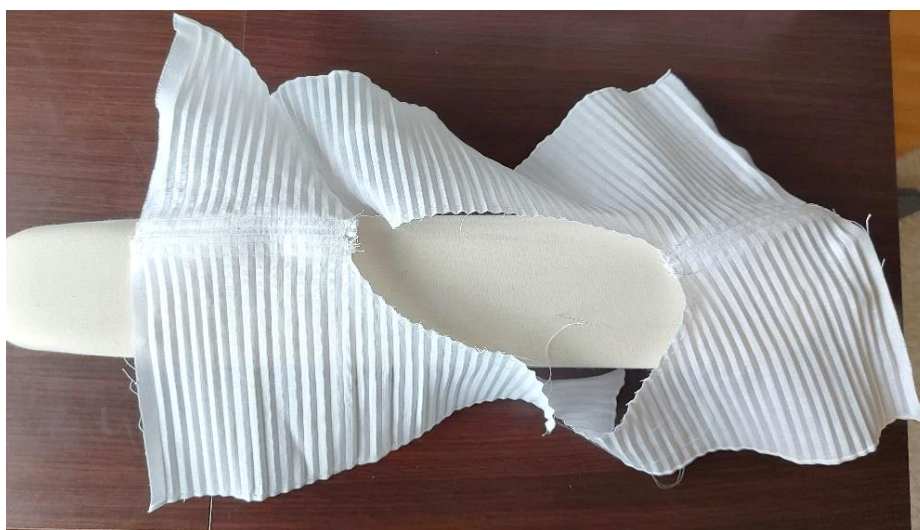
Joonis 34. Käiste kaelaava nõelkurrutamine varrukatriikimise laua toel. Autori foto.
