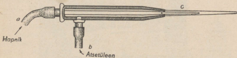
Joon. 18. Atsetüleen-hapnikupõleti skeem:
