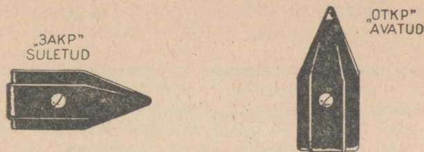
Joonis 8. Kraani käepideme kaks asendit.
