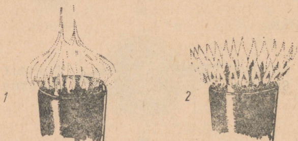
Joonis 10. 1 — põlemine mittenormaalne; 2 — põlemine normaalne.
