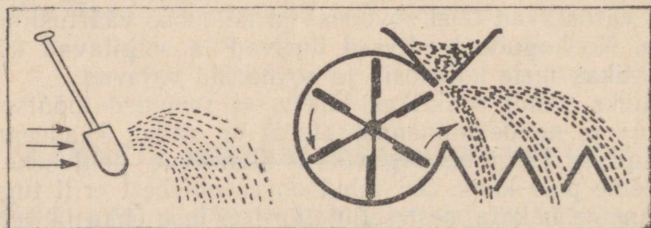
Joon. 140. Tuulamis- ja sorteerimismasina töötamise põhimõtte.
