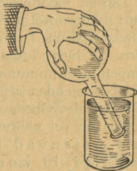
36. joonis. Õhu paisumine soojendamisel.
