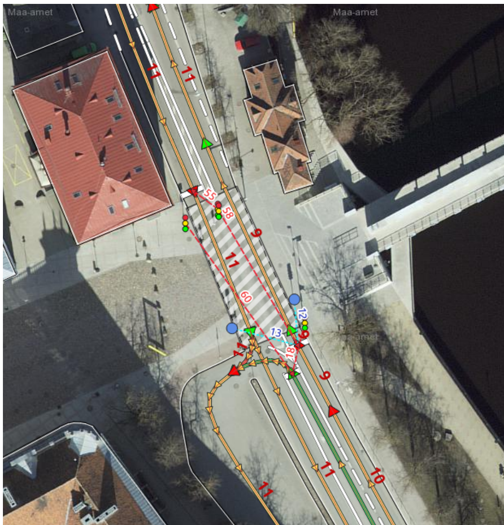
Joonis 2. Tartu Ülikooli isejuhtivate sõidukite labori täppiskaardi näide Tartu raekoja platsi ees
