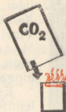
Joonis 38. Bensiini kustutamine süsinikdioksiidiga
