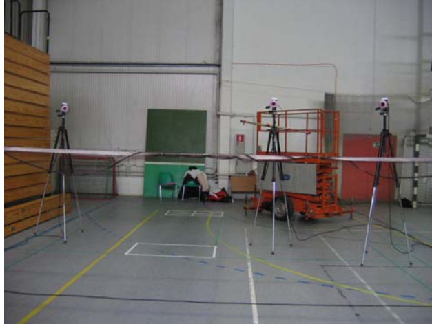
Joonis 10. Infrapunakaamerate paigutus sulgpalliväljaku poolel, kuhu serv sooritati.
