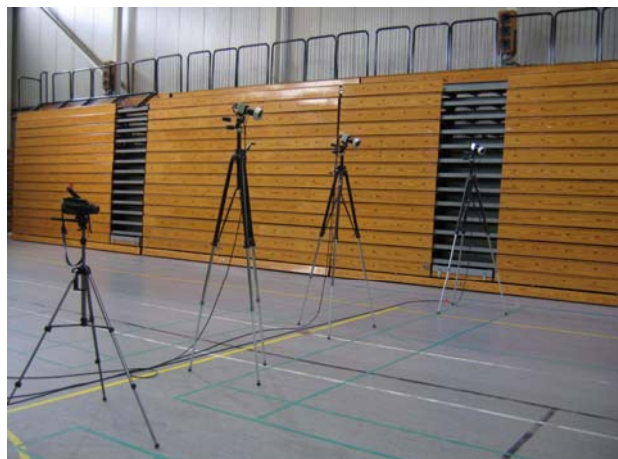
Joonis 9. Infrapunakaamerate paigutus sulgpalliväljaku poolel, kust vaatlusalune servis. Vasakult poolt esimene kaamera on videokaamera, mis jäädvustas kõik katsed, et hilisemate küsimuste tekkimisel oleks võimalik korrata katseid.
