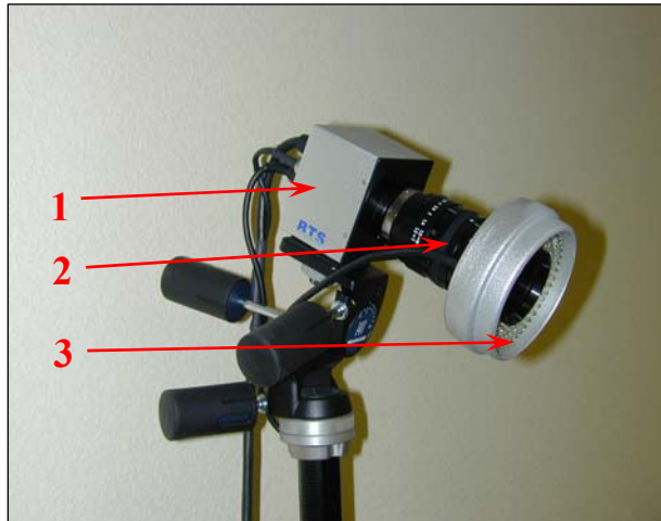
Joonis 8. Infrapunakaamera. CCD tehnoloogial põhinev videokaamera (1), infrapunatundliku suurendusega (zoom) objektiiv (2), rõngakujuline valgusdiodidest koosnev infrapuna valgusallikas ümber infrapunatundliku objektiivi (3).
