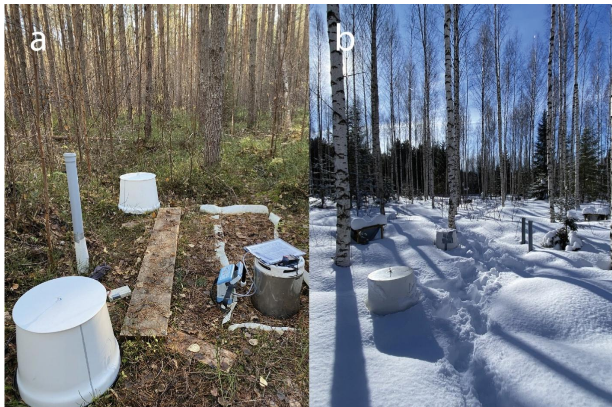
Joonis 4. Fotod Liispõllu männikust ja kaasikust kevad- ja talveperioodil. (a) Vasakul staatilised pimekambrid, nende vahel piesomeeter. Paremalt heterotroofse hingamise mõõtmisala dünaamilise pimekambriga ja CO 2 analüsaatoriga.
