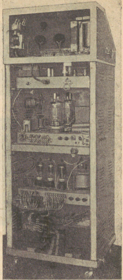
Joon. 42. Joonisel 41 näidatud ultraheliseadme (1,0 kW, 20 kHz) toiteblokk (vaade katteta tagaküljele).
