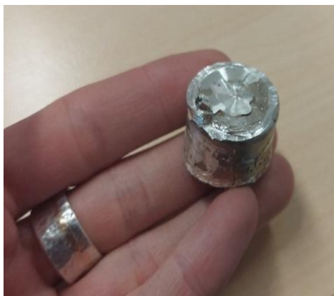
Joonis 25. Treimisel katki läinud hõbedast alus (Foto: Gert Evert)
