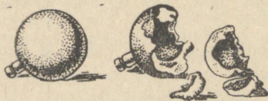
Joon. 50. Vasakul — veega täidetud malmpomm; paremal — sama pomm, purunenud vee jäätumisel.
