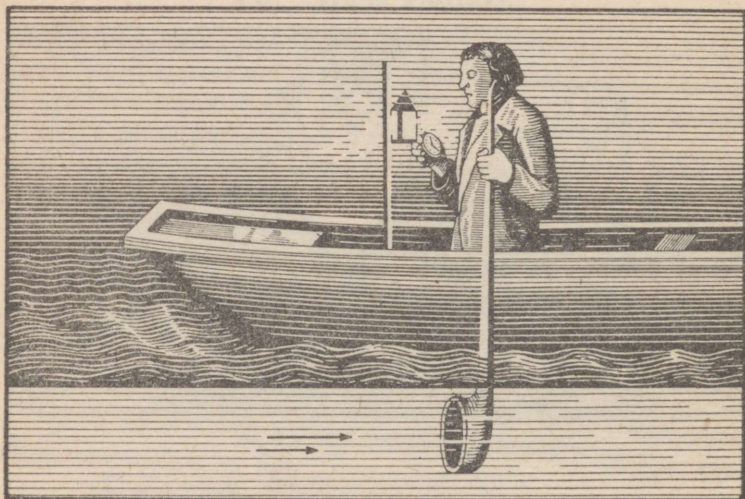
Joon. 11. Hääle kiiruse mõõtmine vees. Siin võtab inimene häält vastu.
