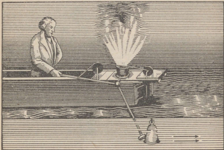
Joon. 10. Hääle kiiruse mõõtmine vees. Selles paadis istuv inimene tekitab häält.
