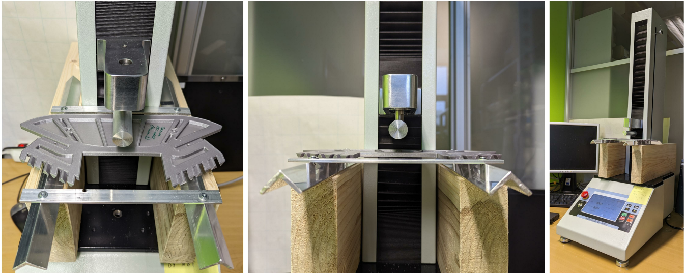
Joonis 25. Jäikuskatse jaoks ehitatud alumiiniumist rakis (raam detaili all ja silindrikujuline detail surve ühtlaseks rakendamiseks) ja detaili paigutus mõõteseadmes
