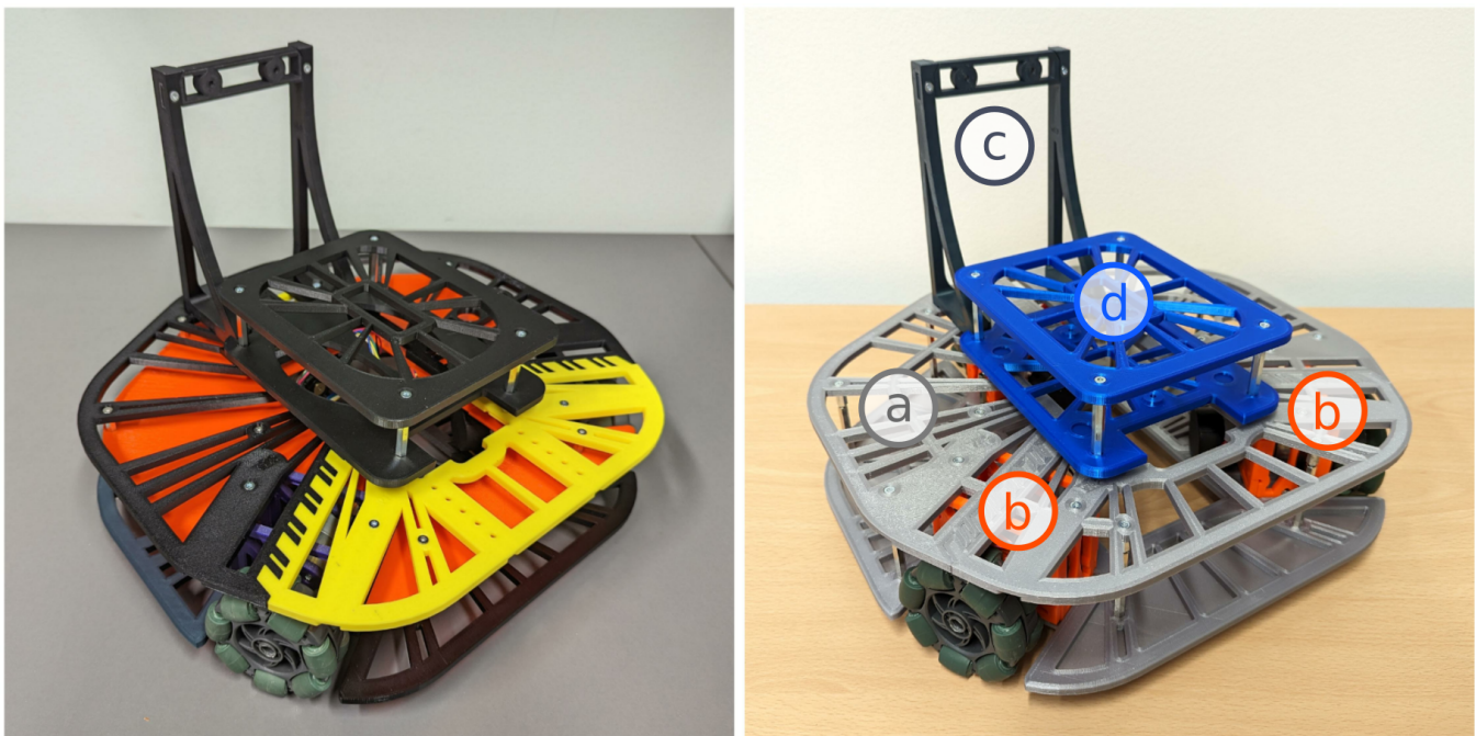
Joonis 9. Ver0.1.0 ja ver0.2.0. Oranž detail vasakpoolsel pildil simuleerib PCB kuju ja suurust. Paremal tähistatud moodulid: raamimoodul (a), mootorimoodulid (b), kaameramoodul (c) ja arvutimoodul (d).
