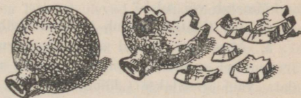
89. joon. Jääks muutudes paisub vesi tugevasti ja lõhub raudpommi.
