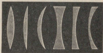
143. joon. Optilised lättsed läbilõikes. 1 — kaksikkumer, 2 — tasakumer, 3 — nõguskumer, 4 — kaksiknõgus, 5 — tasanõgus, 6 — kumernõgus lätts.
