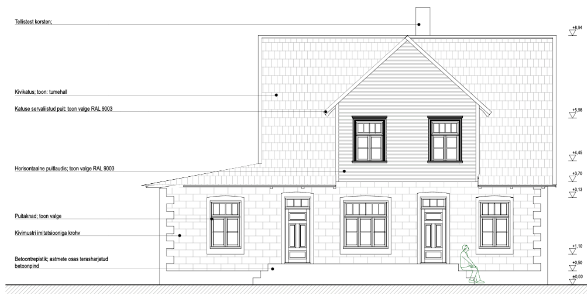
Joonis 15. Väljalõige Pööravere koorejaama rekonstrueerimisprojekti vaatest ida suunast.
