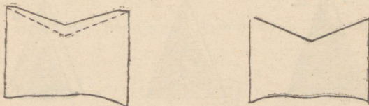
Joonis 6. Hõõvelhamba teritamine. Vasakul hõõvelhammas pärast tasandamist, paremal pärast teritamist.
