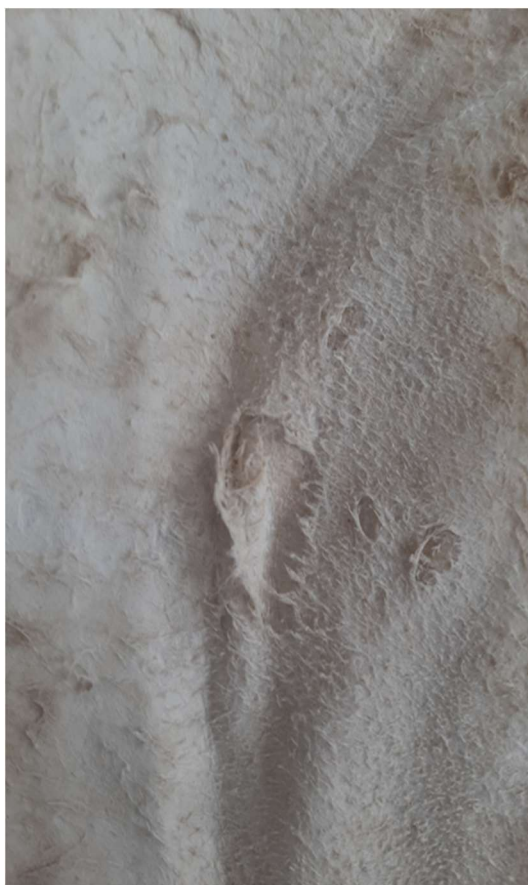
Joonis 52 - Venitusel rebenenud koht, mida eelnevalt polnud õmblysega toestatud II (Foto K. Kolga 2024)
