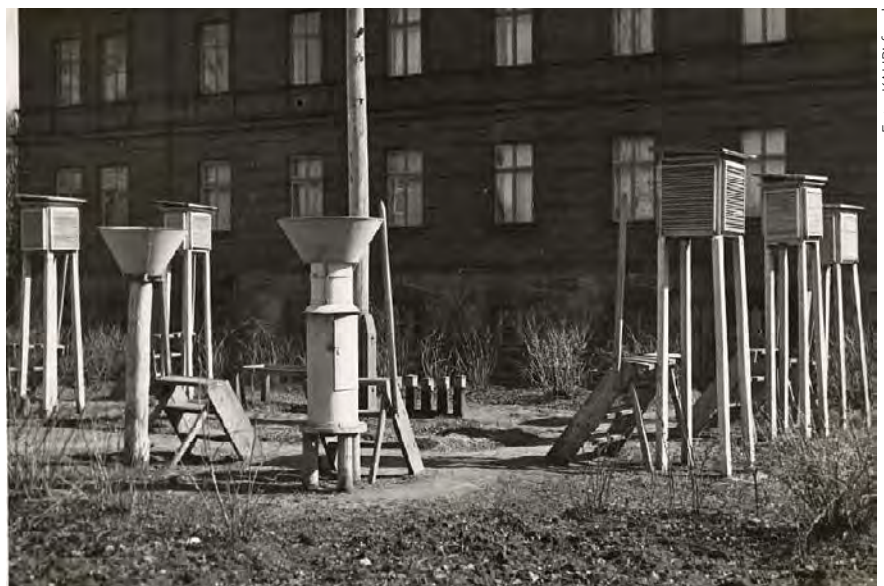
◇ 3. Tartu ilmajaama vaatlusväljak Liivi tänaval 1940. aastail. Fotol on näha lehtrikujulise tuulekaitsega sadememõõturid ja ilmaonnid
