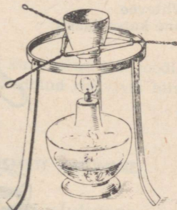
Joon. 13. Seemnete kuumutamine tiiglis.
