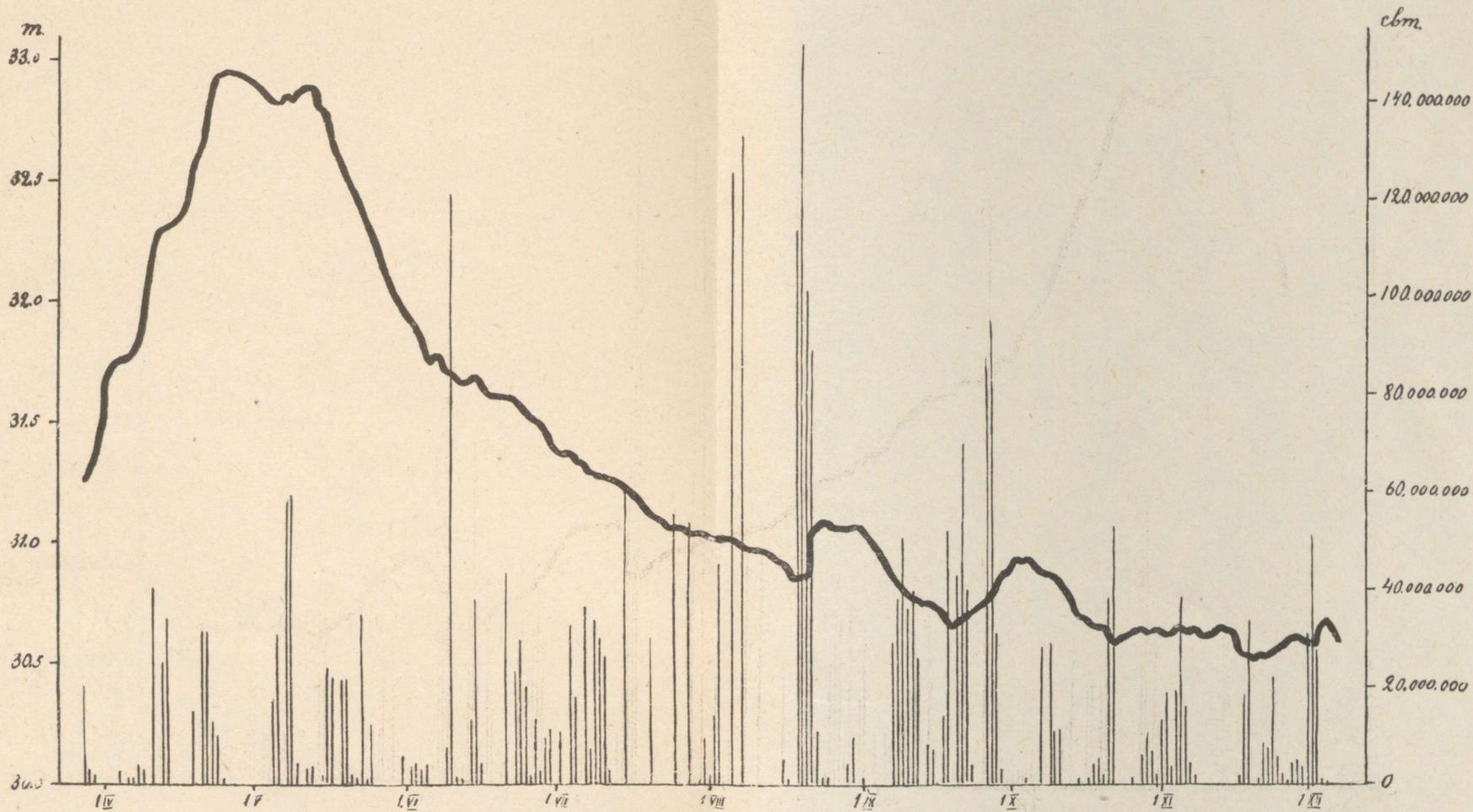
Fig. 2. Tägliche Wasserhöhen und Niederschlagsmengen 1924.
