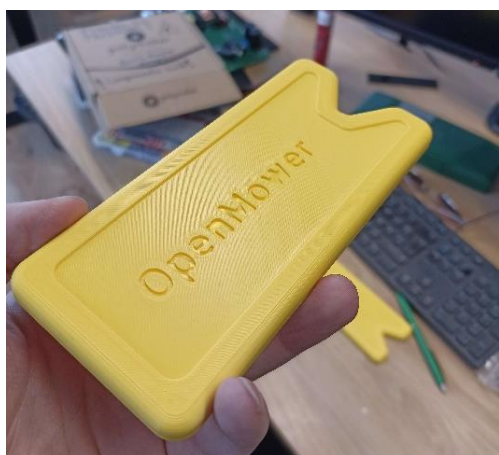
Joonis 5.8 (c): 3D-prinditud baasjaama korpuse küljekate PETG materjalist
