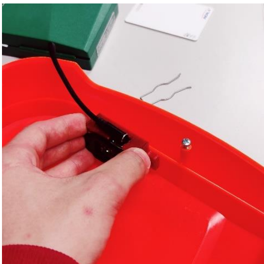
Joonis 5.9: Millimeeter radari kinnituskoh robotis
