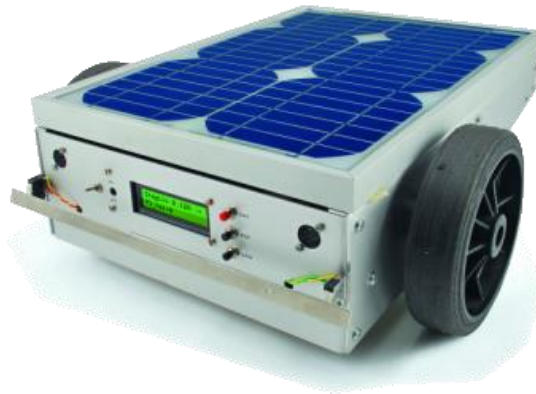
Joonis 2.2 Päikseenergiat töötav robotmuruniiduki lahendus
