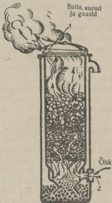
Joonis 85. Punkris oleva põletusaine kuivatamine gasogeeni endatõmbega.
