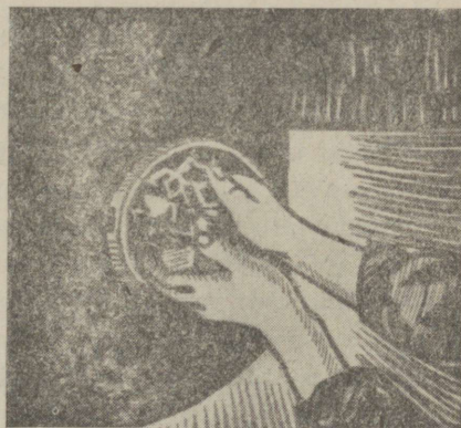
Joonis 74. Täiendava taandamistsooni täitmine puidusöega.
