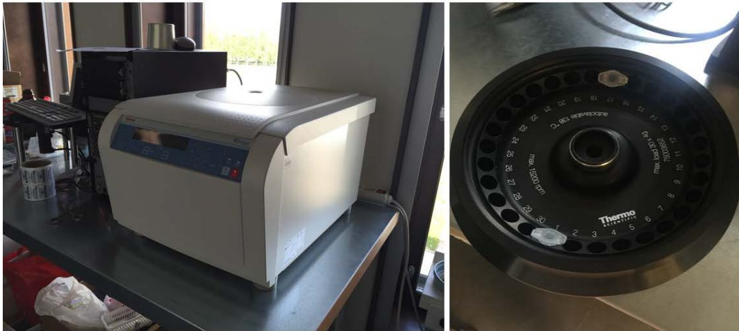
Joonis 10. Tsentrifugimisseade Thermo Scientific Heraeus Multifuge X1 Centrifuge ja antud eksperimendi käigus kasutatud rootor, mille sisse on paigutatud kaks tasakaalustatud eppendorfi tuubi.
