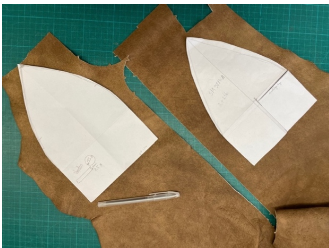
Joonis 54. Mütsi lõigete märkimine nahale
