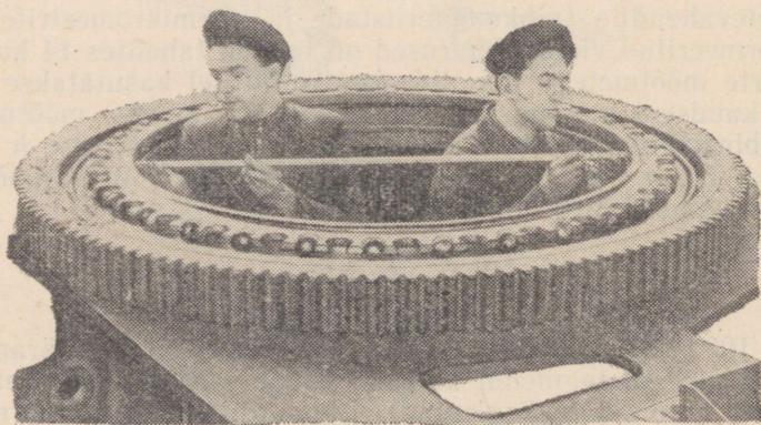
Joon. 56. Augu mõõtmine sisemikromeetriga
