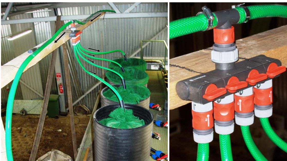
Joonis 5. Nõrgvee jaotussüsteem (parempoolsel pildil lähivaade nelikjaotussüsteemist) katsekolonnidele katses nr. 1 (mustade nooltega märgitud voolusuund).
