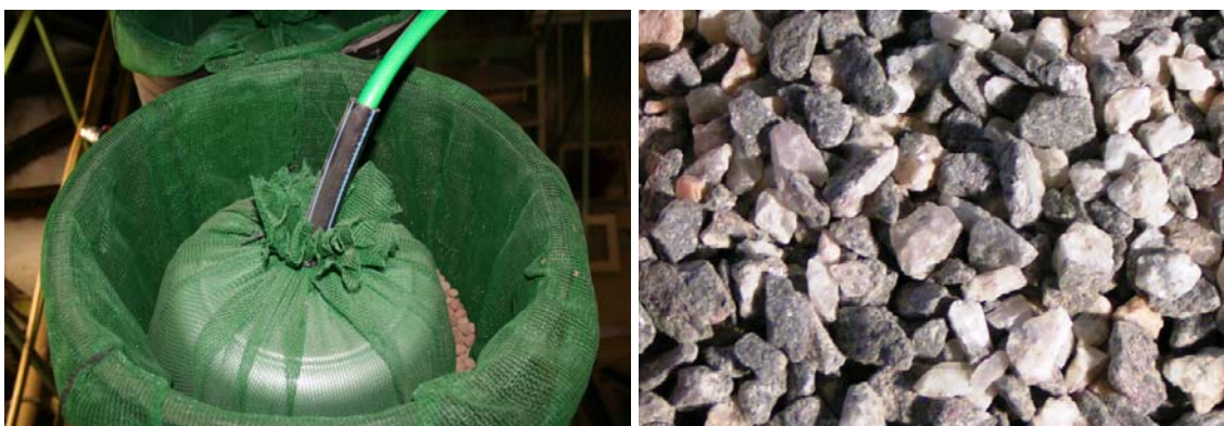
Joonis 6. Filtermaterjalile asetatud nõrgvee nn ühtlustit ning selles kasutatud graniitkillustik (fraktsioon 3-6 mm).
