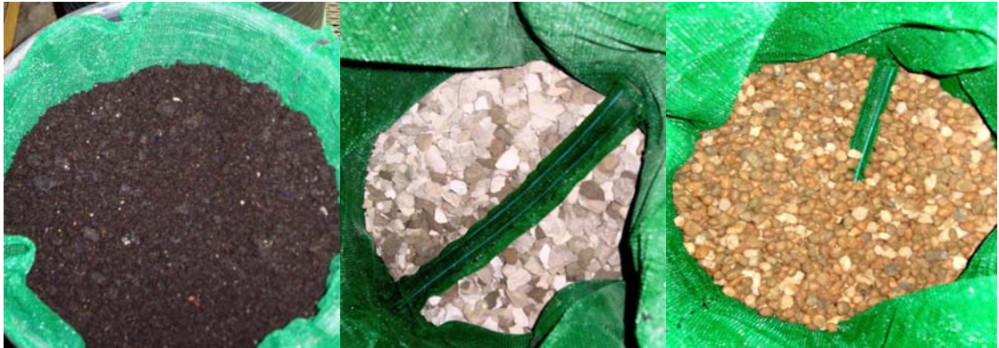
Joonis 8. Filtermaterjalid katsekolonnides (vasakult paremale): turvas (filtrites 1S, 2S ja 1V, 2V), tuhaplatoo sete (filtrites 2S, 3S ja 2V, 3V), kergkruus (filtrites 4S ja 4V).
