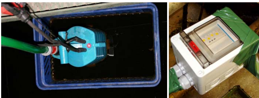
Joonis 9. Katsetes kasutatud pump ja taimer (nõrgvee pumpamise reguleerimiseks).
