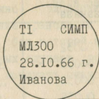
Рис. 9. Пример маркировки магнитной ленты СИМП.
