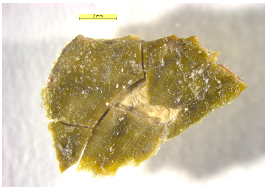
Joonis 49. Icoonilt „Jumalaema Jeesuslapsesega“ võetud kattekihi proovi mikroskoobipilt.
