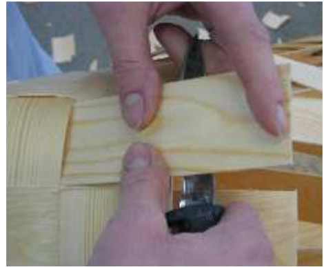
Joonis 137. Korviserva murdmine Foto: E. Tooming
