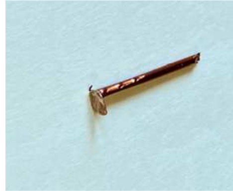
Joonis 22. Vasknaelad (pikkus kuni 20 mm, läbimõõt 0,8–1 mm) Foto: E. Tooming
