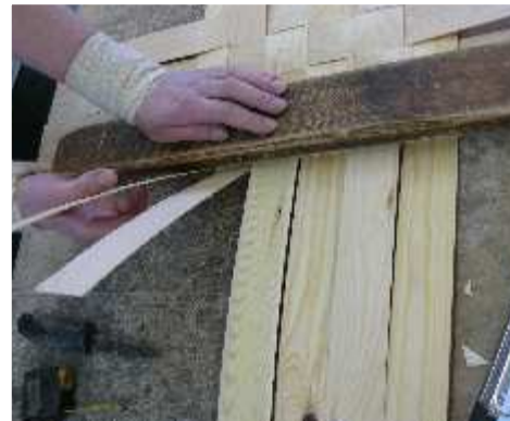
Joonis 117. Põhjalaastude murdmine Foto: E. Tooming
