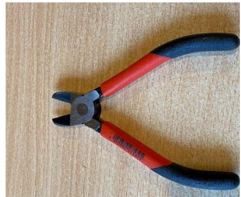
Joonis 14. Lõikuriga näpitsad on vajalikud korvinaelte lühemaks lõikamiseks Foto: E. Tooming
