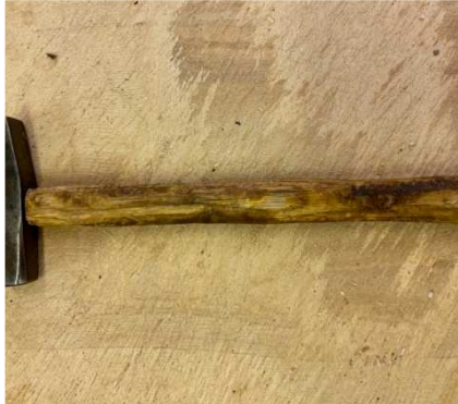
Joonis 112. Haamrit läheb vaja korviserva fikseerimiseks Foto: E. Tooming
