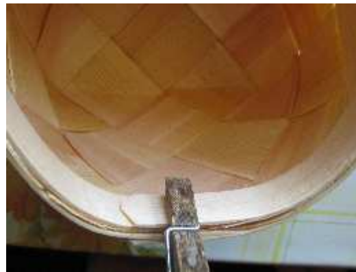
Joonis 49. Sisemise servalaastu lõpetamine. Vaade seestpoolt. Foto: E. Tooming
