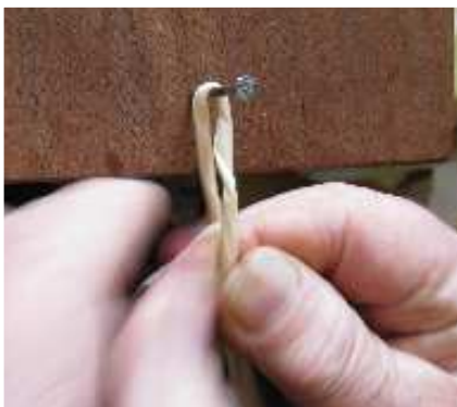
Joonis 96. Laastunööri fikseerimine ja põimimise alustamine
