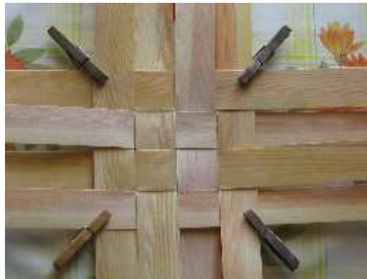
Joonis 30. Neljakandilise korvi põhja fikseerimine. Foto: E. Tooming
