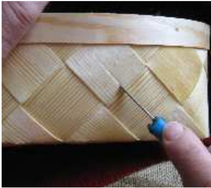
Joonis 69. Sangalaastu koha lõikamine Foto: E. Tooming
