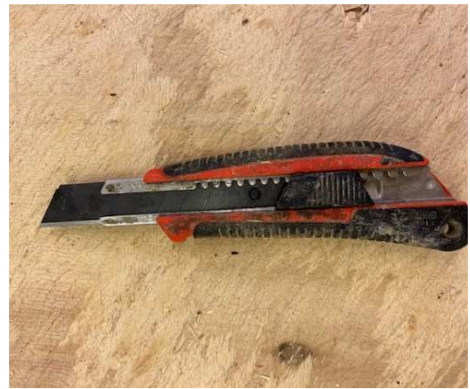
Joonis 105. Vaibanuga kasutatakse korvi viimistlemiseks ja puidupindude jaoks Foto: E. Tooming
