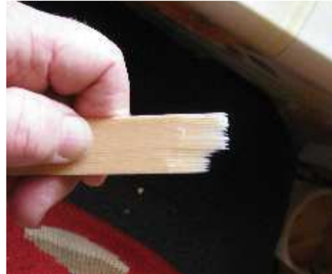
Joonis 46. Murtud servalaastu algus Foto: E. Tooming
