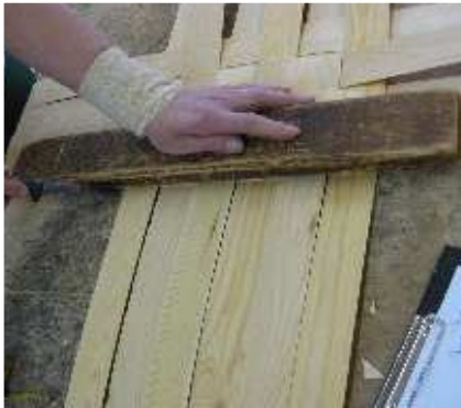
Joonis 102. Murdmise klopp (pikkus 58 cm, läbimõõt 3,5 cm)
