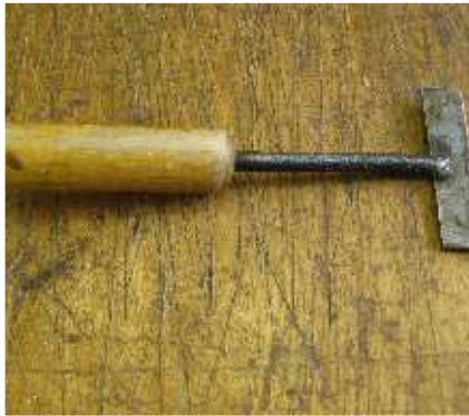
Joonis 104. Laastude murdmise abivahend Foto: E. Tooming
