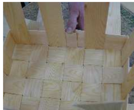
Joonis 123. Laastuvöö fikseerimine põhjale Foto: E. Tooming
