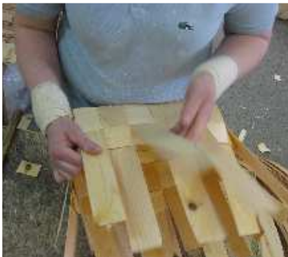
Joonis 132. Korvikülgede pingutamine Foto: E. Tooming
