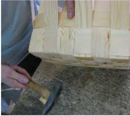
Joonis 130. Korvipõhi fikseeritakse haamriga Foto: E. Tooming
