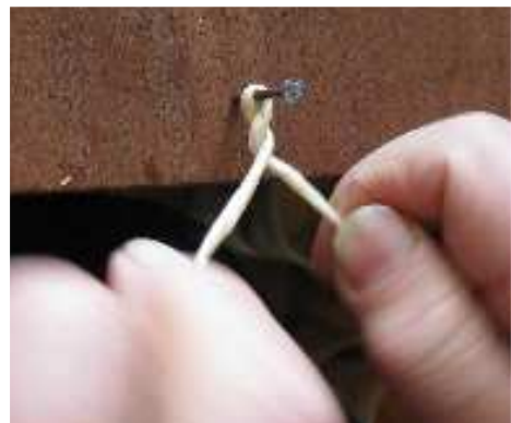
Joonis 97. Nööri punumine. Laastunööre keeratakse vastassuunas ja põimitakse kokku nööriks
