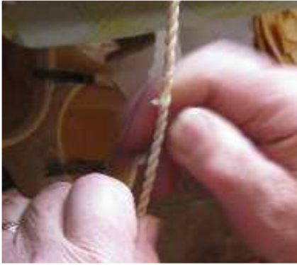
Joonis 98. Keerutatud laastust nööri Foto: E. Tooming
