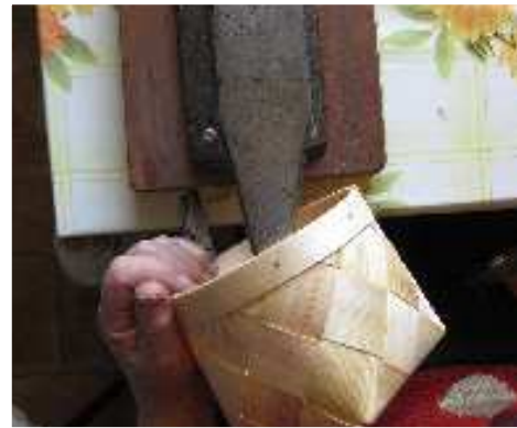
Joonis 53. Sisselöödud nael väljastpoolt vaadatuna Foto: E. Tooming
