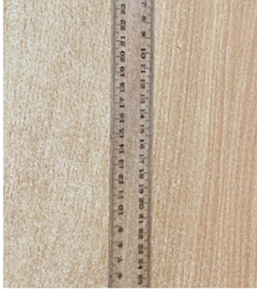
Joonis 13. Joonlaud on korvipõhja diagonaali märkimise ja korvipõhja murdmise tööriist Foto: E. Tooming
