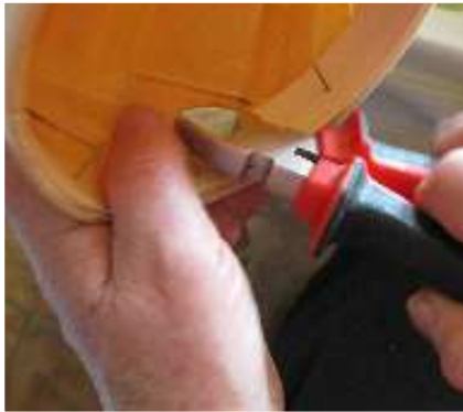
Joonis 55. Pikkade naelte mõõtulõikamine Foto: E. Tooming
