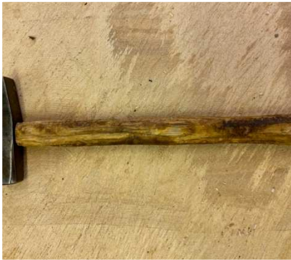
Joonis 17. Väike haamer korvinaelte naelutamiseks Foto: E. Tooming
