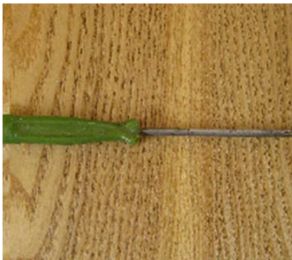
Joonis 15. Naelakeerajat kasutatakse korvinaelte keeramiseks Foto: E. Tooming
