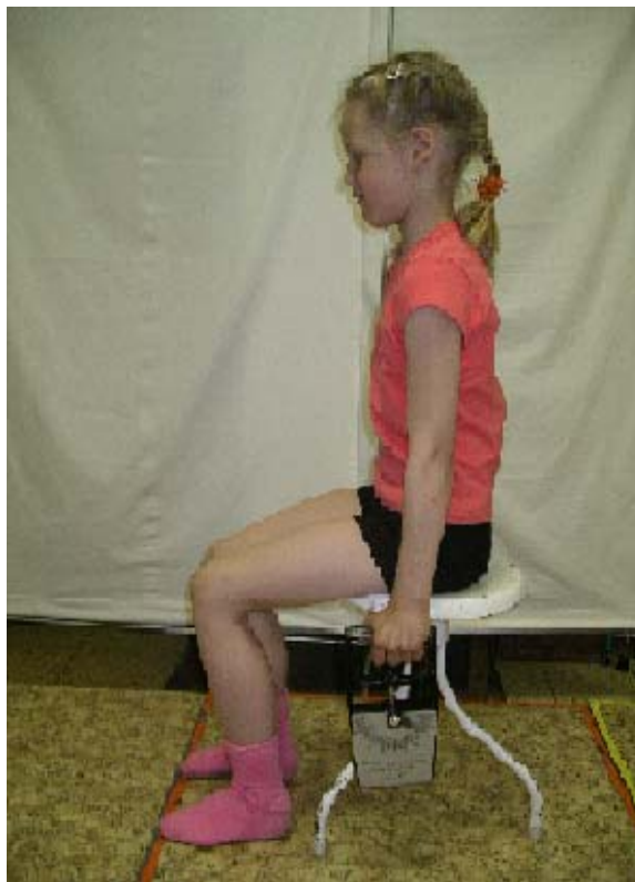
Joonis 6. Käelihaste isomeetrilise maksimaaljõu registreerimine standardse käe dünamomeetriga Lafayette Instrument Hand Dynamometer Model 78010
