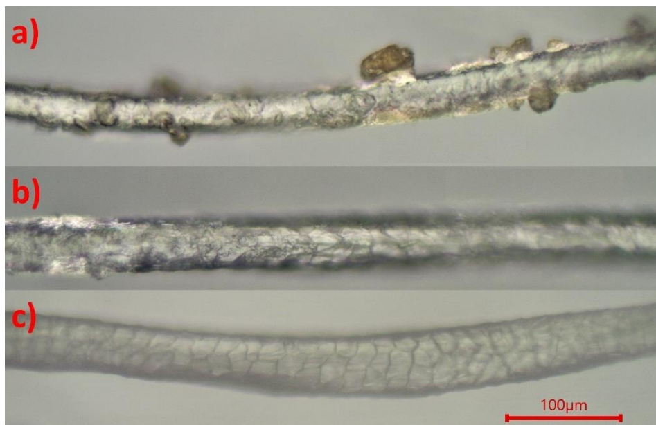
Joonis 12. OM mikrograafid a) purustatud villast enne töötlust, b) pH 12, 30 min töödeldud purustatud villast ja c) pH 8, 10 min töödeldud purustamata villast
