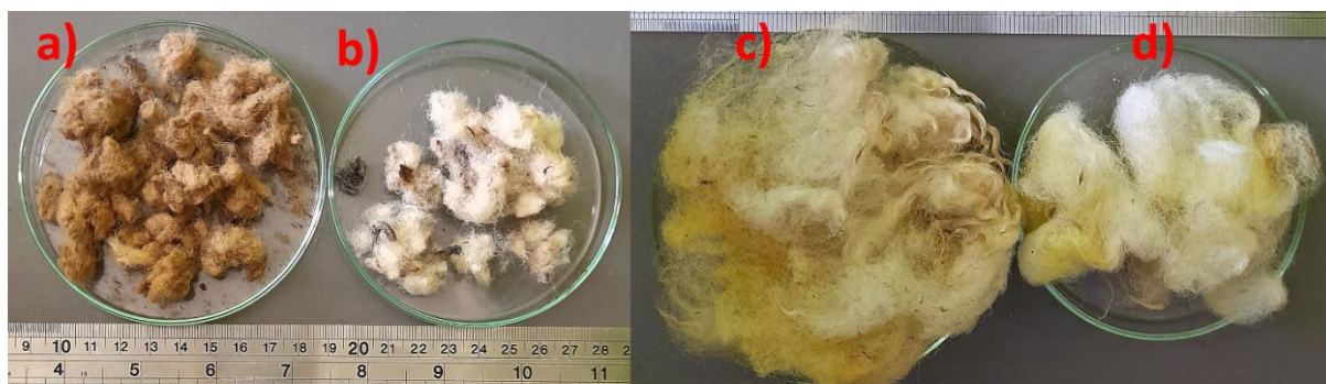
Joonis 9. Purustatud (pikk) vill a) enne ja b) pärast pesemist ning purustamata vill c) enne ja d) pärast pesemist
