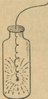
52. joonis. Terastraadi põlemine hapnikus.
