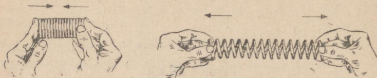
Joon. 27. Terasvedru surutakse kokku ja venitatakse välja.
