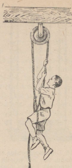
Joon. 119. Ule liikumatu ploki on pandud nõör, mille ühes otsas on silmus, kuhu on asetatud võimleja jalg, teist otsa tõmbab võimleja, tõstes iseennast.
