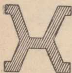
Joon. 6. Meetri etaloon (algmeeter).
