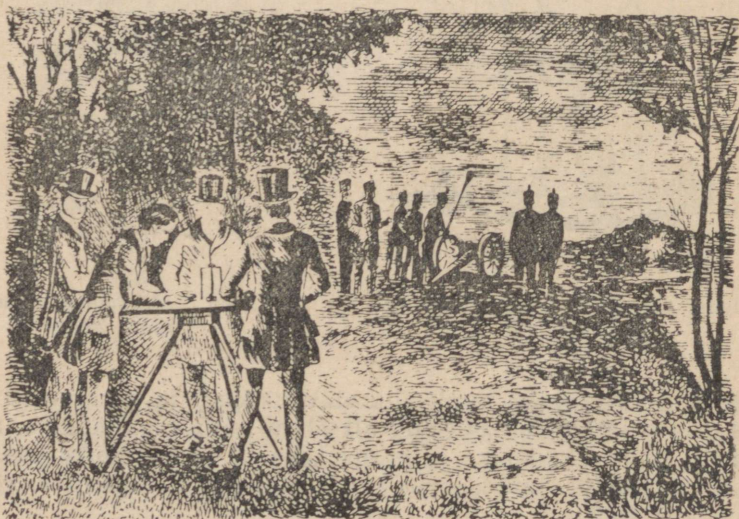
Joon. 158. Vanaaegne gravüür, mis kujutab hääle levimise kiiruse määramist õhus.
