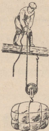
Joon. 114. Tööline, kes seisab palgil, mille külge on kinnitatud üks nööri ots, tõmbab nööri teist otsa pidi, tõstes üles liikuvat plokil rippuva koormuse.
