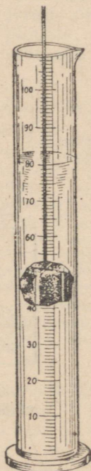
Joon. 13. Vett sisaldavasse mensuuri on asetatud tahke keha, mille ruumala mõõdetakse.
