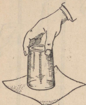
Joon. 66. Paberilehega kaetud kummulipõõratud klaasist vesi ei voola välja.
