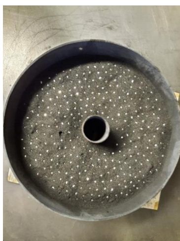
Joonis 17 ja 18. Graanulite valmistamine: hõbedatükikesed teraskarbis ja teraskarp ahjus. (Autori fotod)
