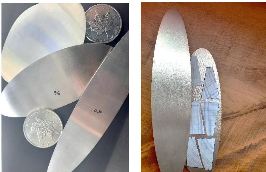
Joonis 19 ja 20. Valtsitud hõbe ja saagimisele minevad trapetsripatsid. (Autori fotod)
