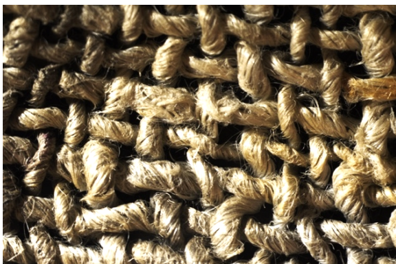
Joonis 16. Puhastamata linase tekstiili pind, katsekeha nr 8. Suurendus *9,8. Autori foto
