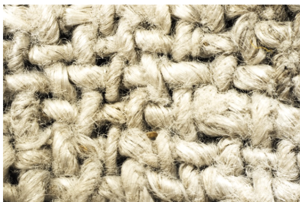
Joonis 18. Puhastatud Sensene lahustiga linase tekstiilipind, katsekeha nr 8, suurendus *9,8. Kiud on pulstunud. Autori foto
