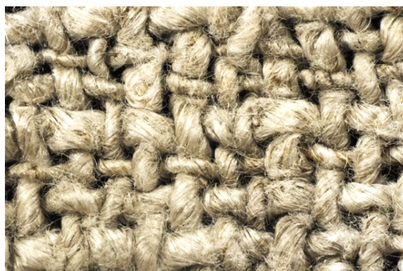
Joonis 17. Puhastatud Perc lahustiga linase tekstiili pind, katsekeha nr 8, suurendus * 9,8. Kiud on pulstunud. Autori foto
