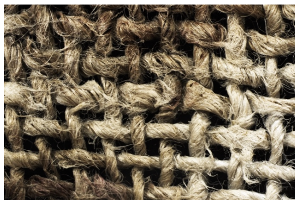
Joonis 19. Puhastatud veega linase tekstiilipind, katsekeha nr 8, suurendus *9,8. Autori foto
