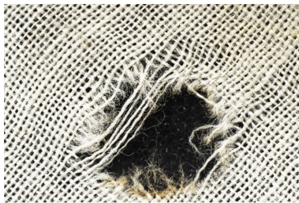
Joonis 23. Puhastatud Sensene lahustiga katsekeha nr 34 pind. Pleki kohal auk suurenes. Suurendus *9,8. Autori foto
