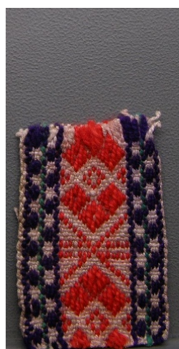
Joonis 12. Puhastatud Sensene TM lahustiga. Autori foto
