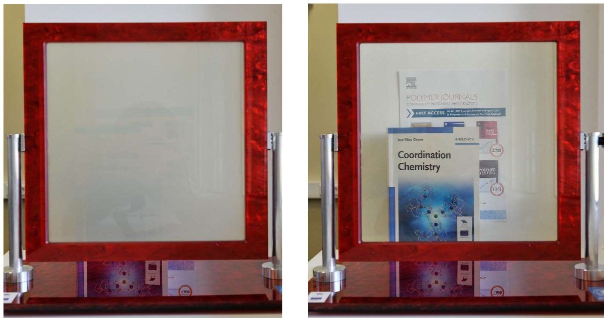
Joonis 2. Sool-geel faasialduse meetodil valmistatud elektrooptiline GDLC materjal välja- (vasakul) ja sisselülitatud (paremal) olekus (avaldamata materjal, M. Timusk). Hoolimata mõõdukalt heast läbilaskvuse muutusest on sellel tehnoloogial fundamentaalsed ületamatud probleemid, mis on seotud ebastabiilsuse ja väga kõrge tööpingega.
