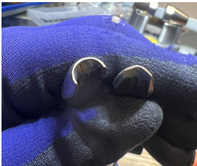
Joonis 15. Servaraiumise meislid on valmis karastamiseks
