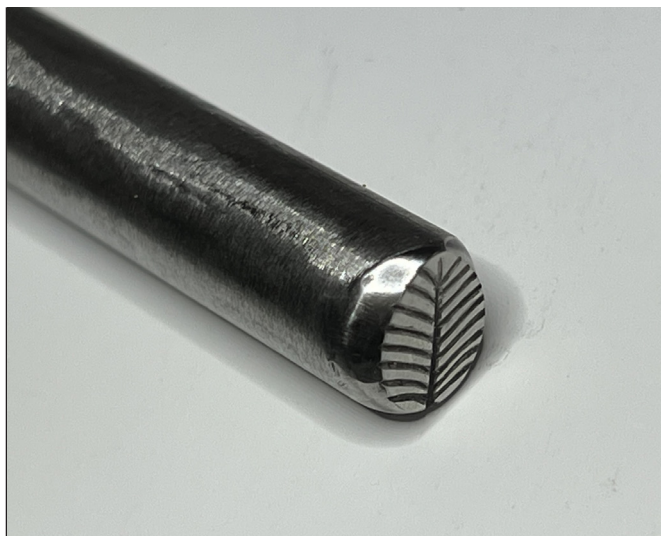
Joonis 19. Lehekujulise puntsi juures on oluline mustripinna kuju hoolikalt ette valmistada
