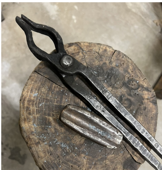
Joonis 14. Tooriku hoidmiseks sobivad sepapihid ja kumera süvendiga alasi
