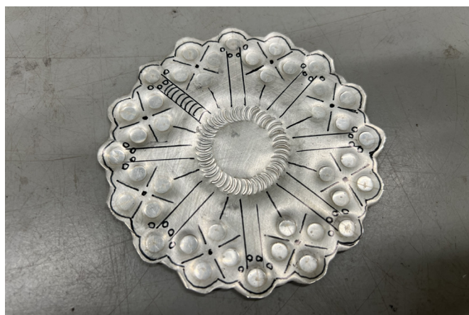
Joonis 27. Peale lõõmutamist tuli muster uuesti markeerida
