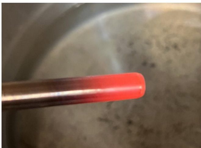
Joonis 10. Puntsi ots peab enne vees jahutamist olema saavutanud porgandi oranži tooni
