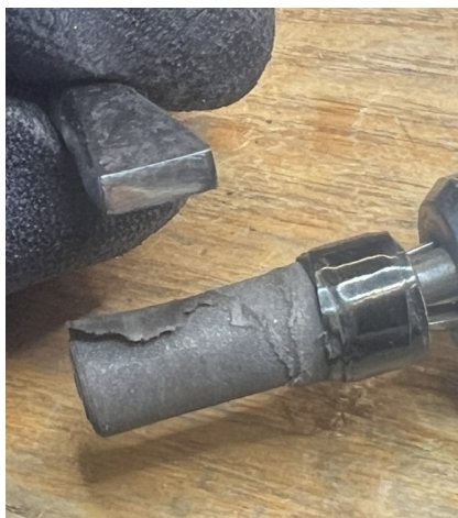
Joonis 16. Liivapaperi rulliga lihvimisel on oluline jälgida, et puntsiotsa pind ei läheks kumeraks
