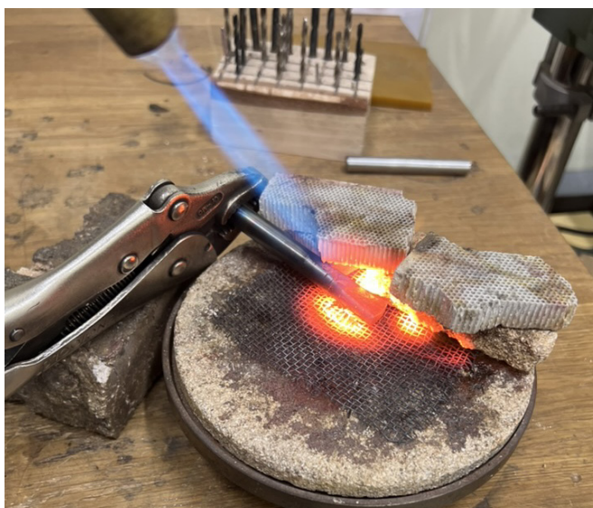
Joonis 13. Sepistamise käigus tuli toorikut korduvalt kuumutada
