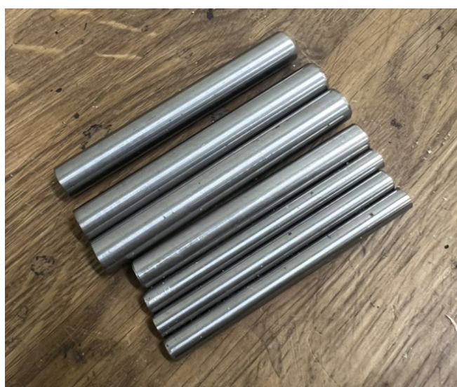
Joonis 6. K510 terase latist lõigatud toorikud
