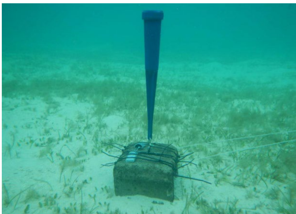
Lisa 2 joonis 3. Marotte HS merepõhja kinnitatuna voolukiirust ja -suunda mõõtmaks (James Cook University, i.a).
