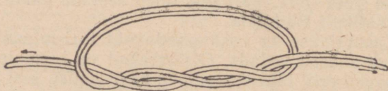
53. Kalamehesõlm õngenööri jätkamiseks.
